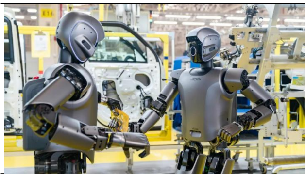
图表 3: 优必选工业人形机器人 Walker S1 在极氪 5G 智慧工厂执行柔软物体灵巧操作任务
