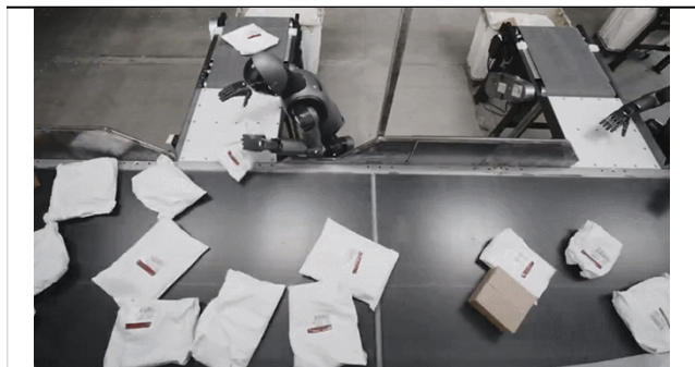
图表 4: Figure 02 机器人物流分拣，零样本处理扁平包裹
