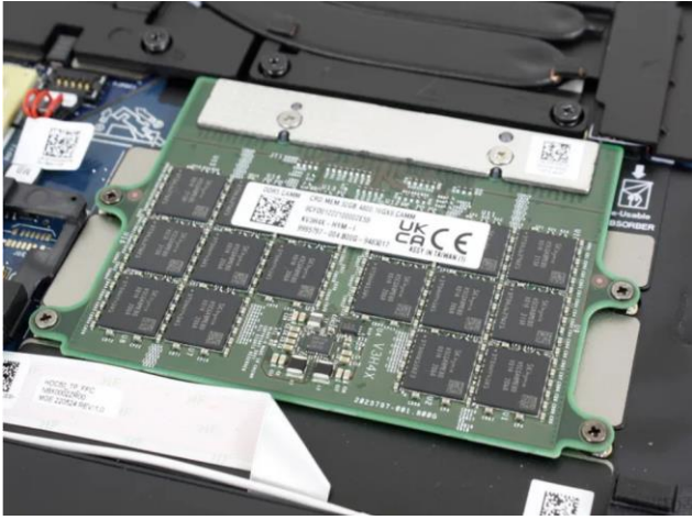
图表 56. CAMM 模组示意图
