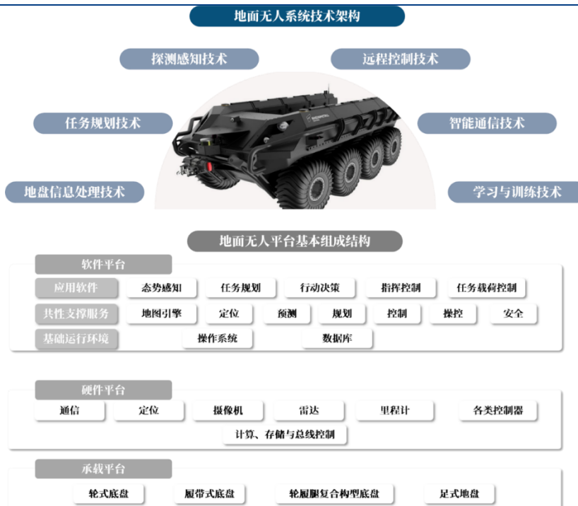
图32 地面无人系统技术架构及平台组成
