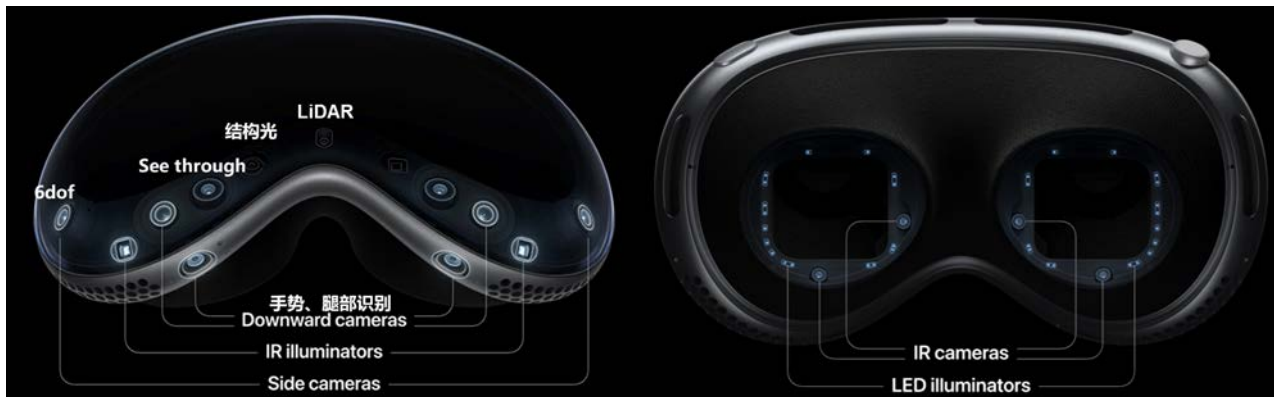
图表: Vision Pro传感器配置 (摄像头*12+传感器*5)
