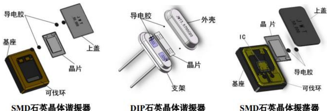
图表 10：各类石英晶振结构图
