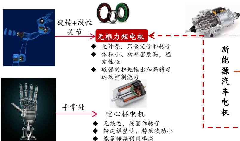
图表：人形机器人各关节电机类型示意图
