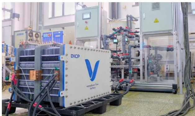
图 40：大连化物所研发出新一代全钒液流电池电堆
