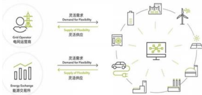
图 15：德国 Next Kraftwerke 虚拟电厂系统架构图
