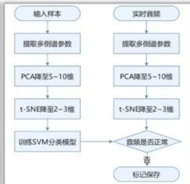
换流阀声纹异常诊断流程
