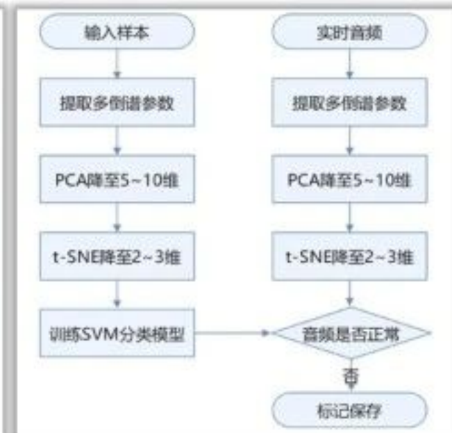
换流阀声纹异常诊断流程
