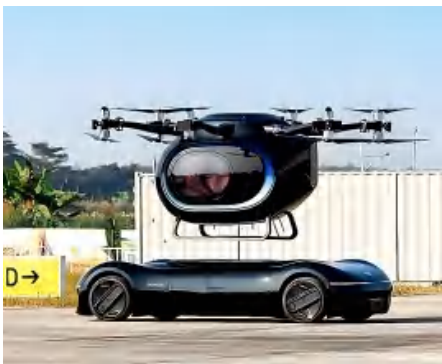
图 2-3 分体式飞行汽车
