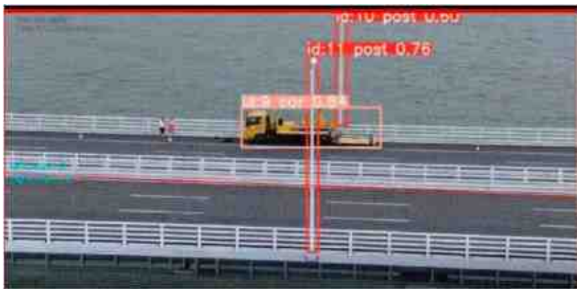
图2-17 无人机识别桥面异常停车
