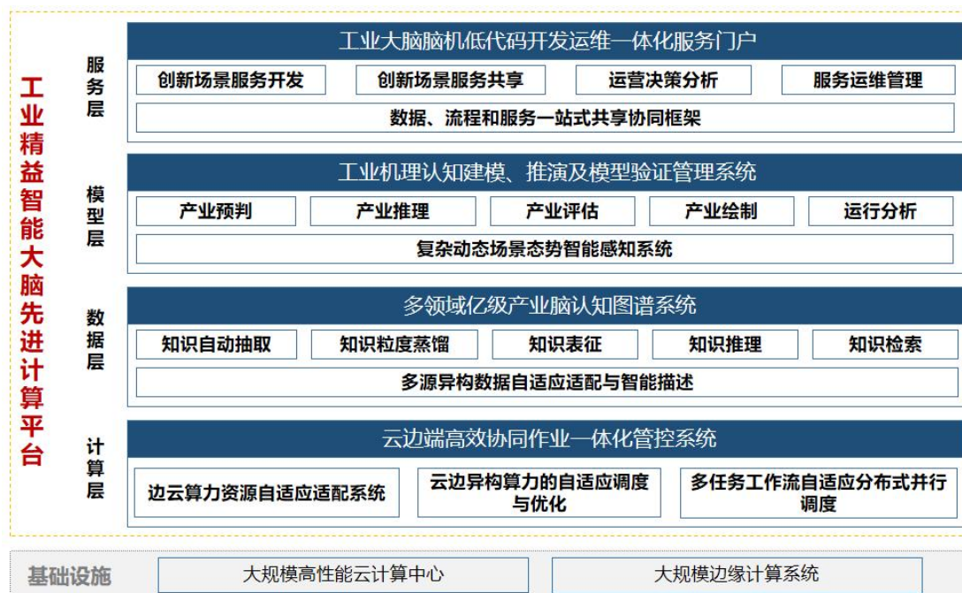
图 2 工业精益智能大脑先进计算平台整体架构图
