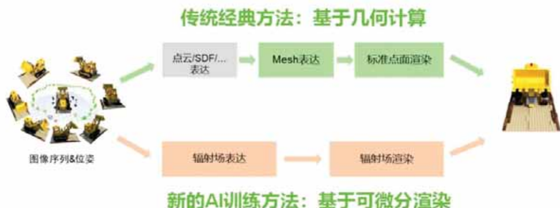
图 2-16 可微渲染引导的三维重建：将建模变成 AI 训练的过程
