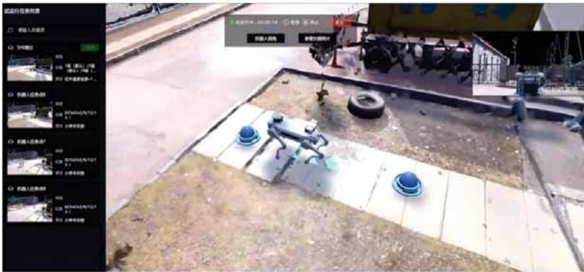
图 4-7 华能会理三地风电场升压站机器人部署模拟仿真
