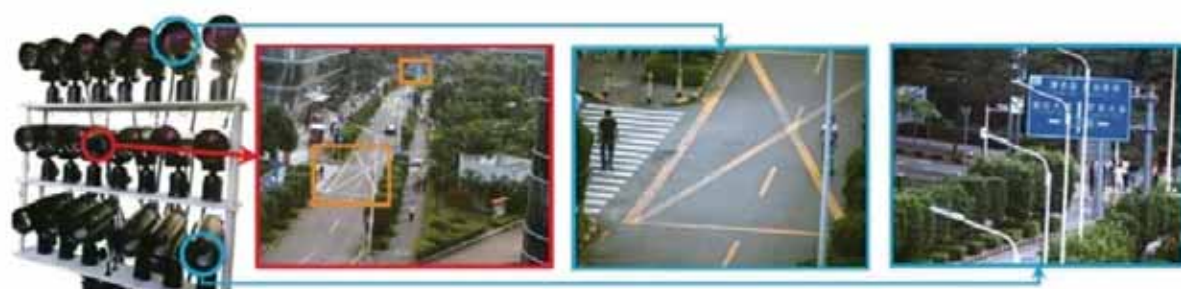
图 2-5 非结构化异构像传感器阵列[15]
