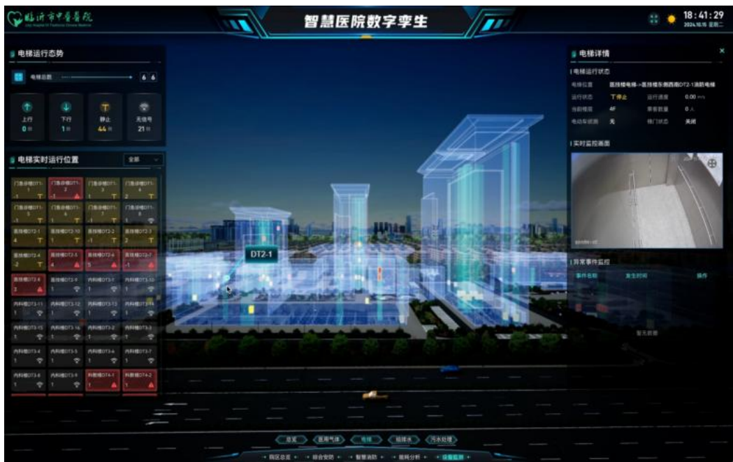
图 102 电梯运行实时监测
