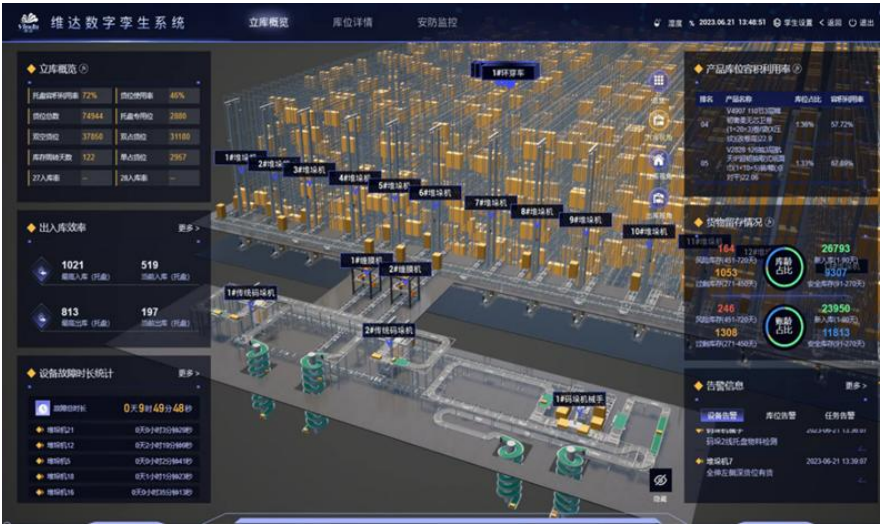
图 60 立库运行实时监测
