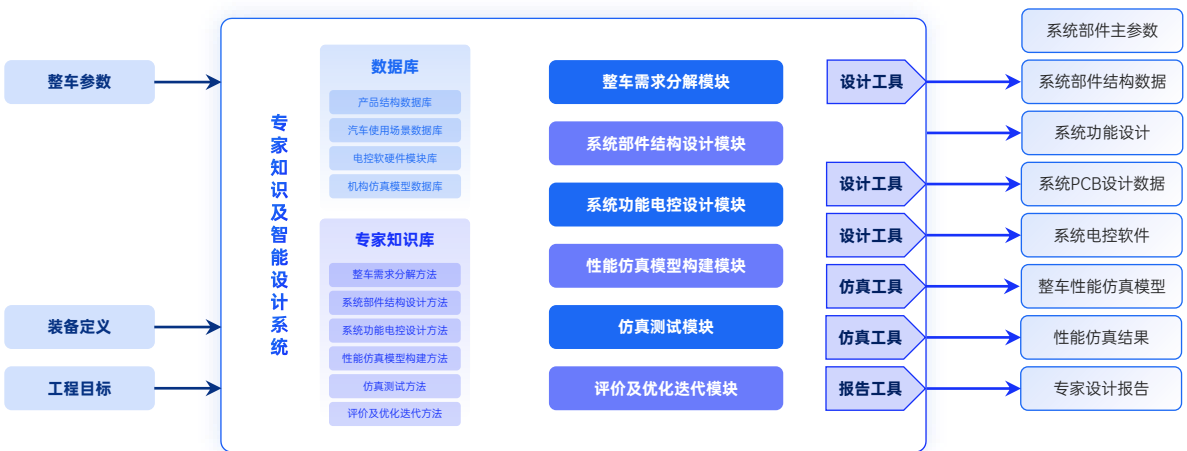
图2.2-1 汽车设计AIGC系统构成
