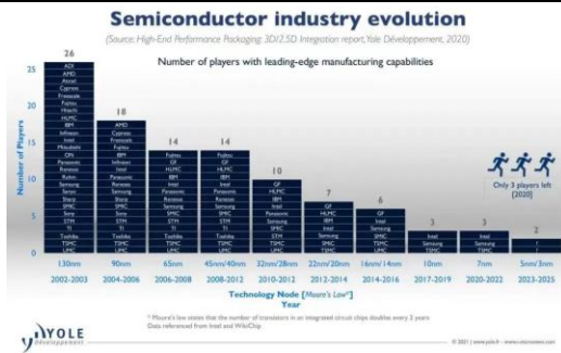
图 101: 半导体制造工艺节点演进路线图
