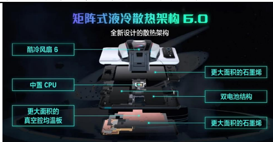
图 22：腾讯 ROG 游戏手机 6 系列矩阵式液冷散热架构示意图
