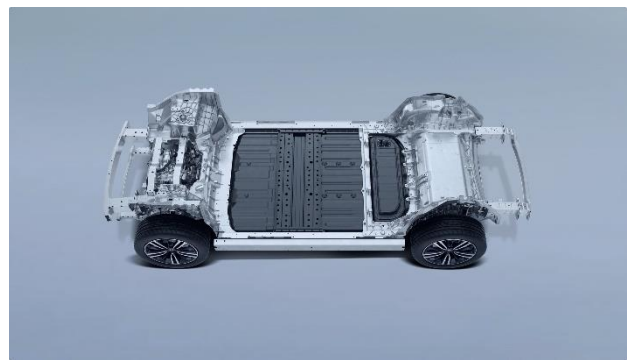
图表 44：CIB 电池车身一体化提升车辆驾控性能
