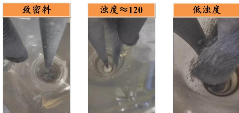
图表 16：颗粒硅质量小、圆球状，低浊度颗粒硅粉含量低于致密块料
