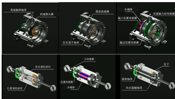
图 41：特斯拉人形机器人采用的旋转和线性执行器示意图
