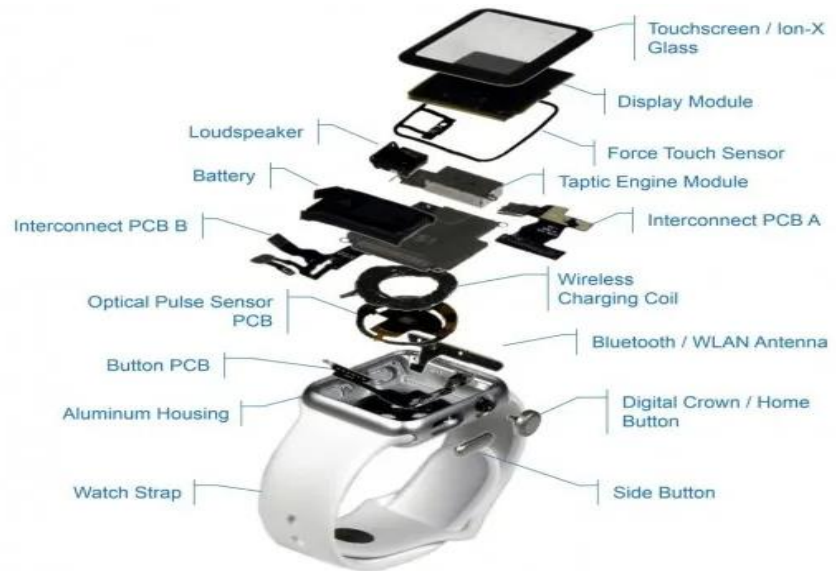
图 22：Apple Watch 结构拆分
