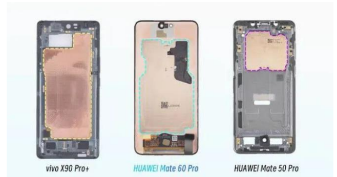
图 88：大面积 VC 均热板+氧化石墨烯散热材料成为散热主流
