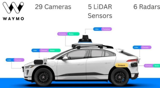
图：Waymo-Robotaxi传感器配置(Gen5)
