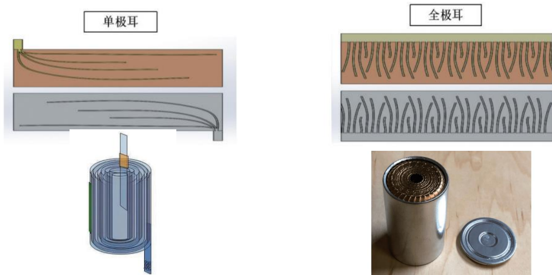
◆图：4680电池最大的结构创新是全极耳，对激光焊接技术要求较高
