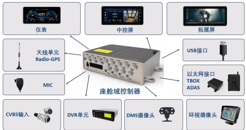
图23: 智能座舱内需要使用连接器的部件图
