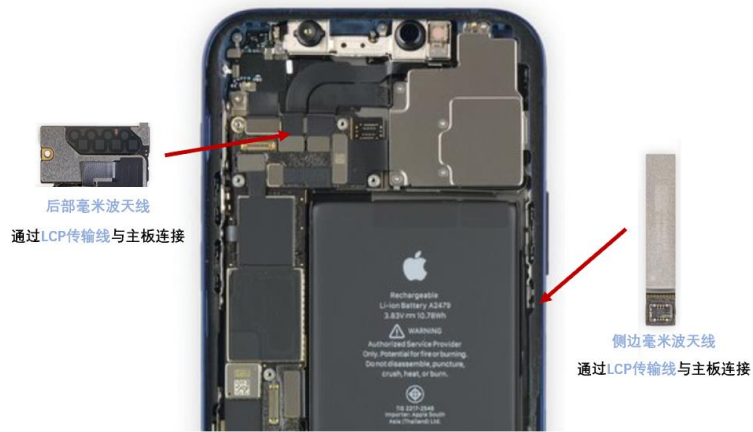
图36: iPhone12 (支持毫米波版本) 两根毫米波天线均采用 LCP 传输线
