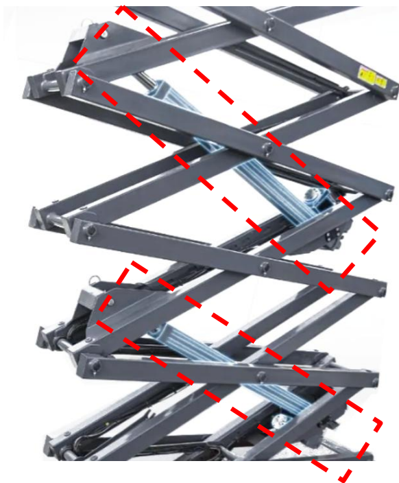
图：浙江鼎力无油全电双电推杆结构
