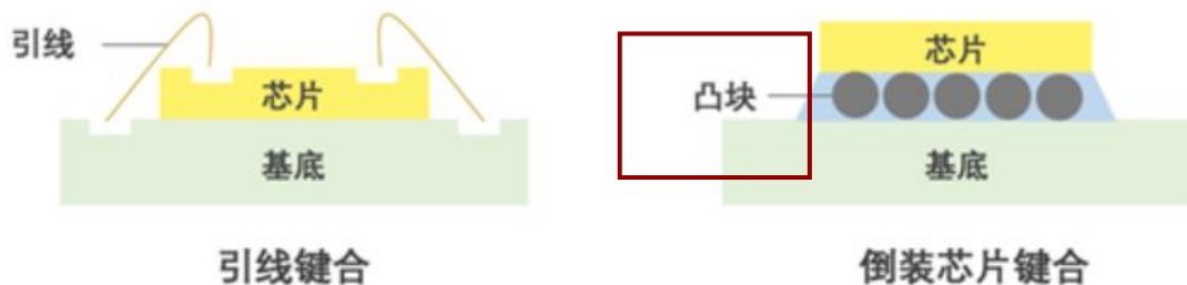
◆ 图：凸块替代原有的引线将芯片与基底进行连接
