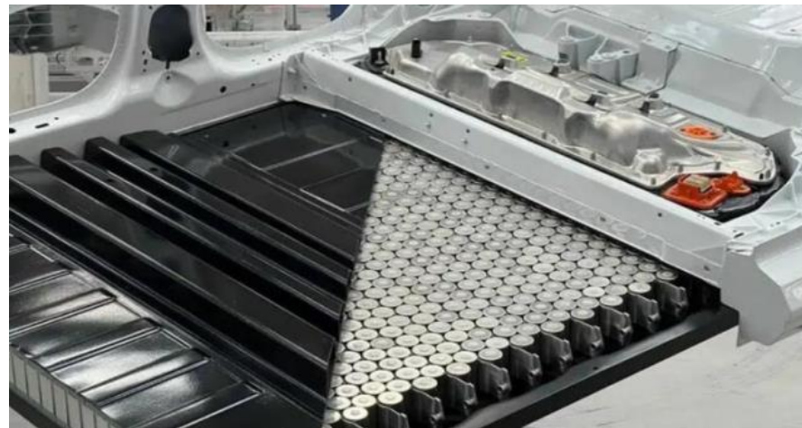
图34：特斯拉4680电池填充聚氨酯材料
