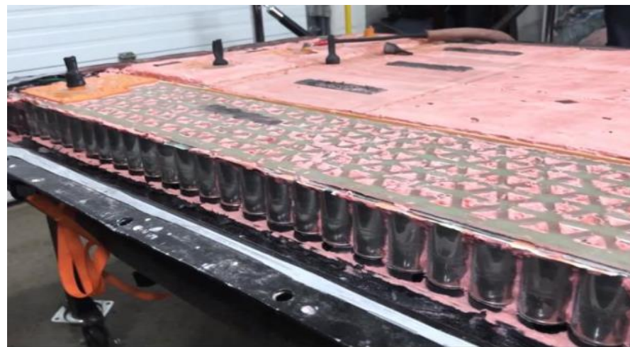
图34：特斯拉4680电池填充聚氨酯材料
