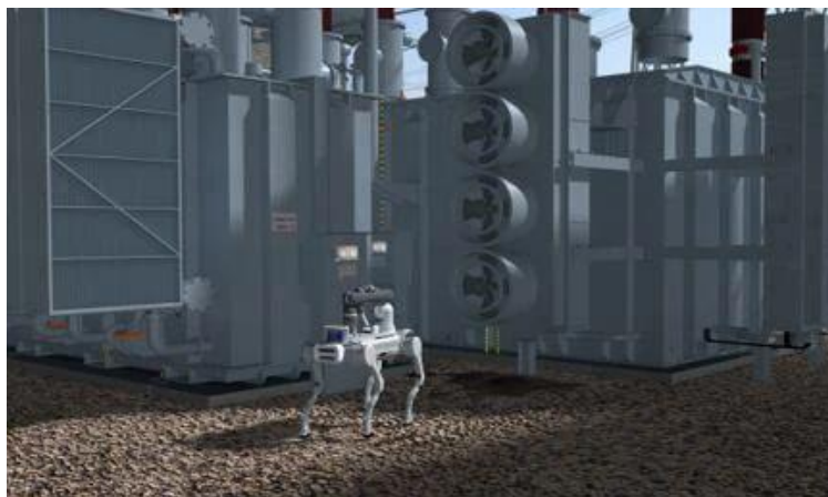
图 29 联想晨星足式机器人巡检系统
