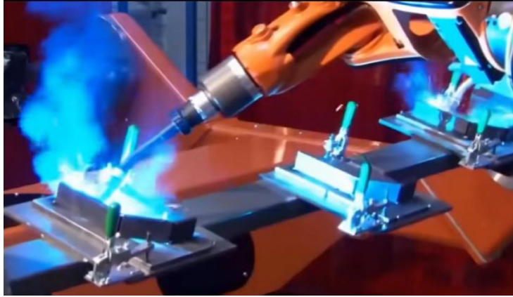
图 39 优复博储罐浮舱智能焊接机器人在辽宁完成验证
